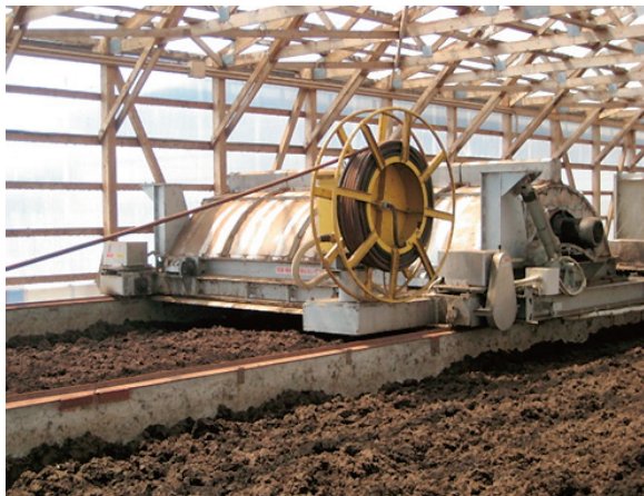
図2 堆肥発酵レーン(白沢有機センター) 一回の攪拌で約1.2 m 移動する
