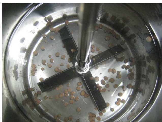
図3 冷媒（シリコンオイル）中で凍結したスラリーの様子 写真撮影のため、攪拌翼を停止させている。
