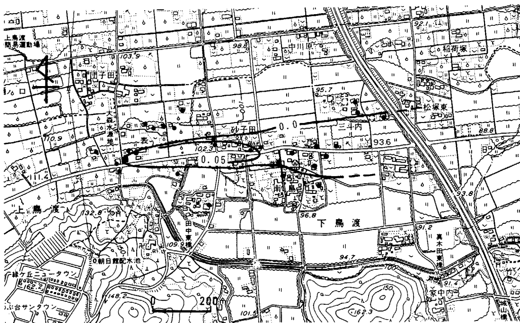
図11 上鳥渡地区のPCEによる地下水の汚染範囲(単位はmg/l) 黒丸は調査井
