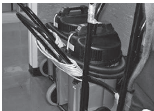
写真3 吸水のための強力なバキューム
