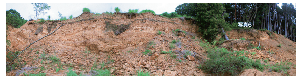
図3-5 A・B軽石層上位の厚い砂質ローム質粘土層とその上位の黒色土壌と盛り土
