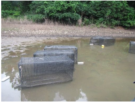
図1 原発周辺のため池で実施したケージ試験の様子（左）と日本ウナギの Cs-137 濃度の推移（右）
